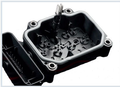
Bild 4. Für die Gehäuse von elektronischen Steuergeräten sind leichtfließende, hydrolysestabilisierte, flammwidrige und laserschweißfähige PBT-Typen erhältlich (© BASF)
